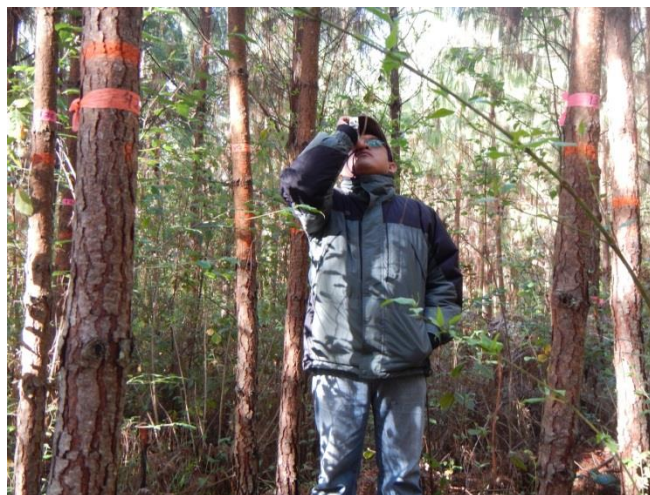
Figura 11. Medición de la altura con hipsómetro Vertex IV para arboles mayores a 8 m.
