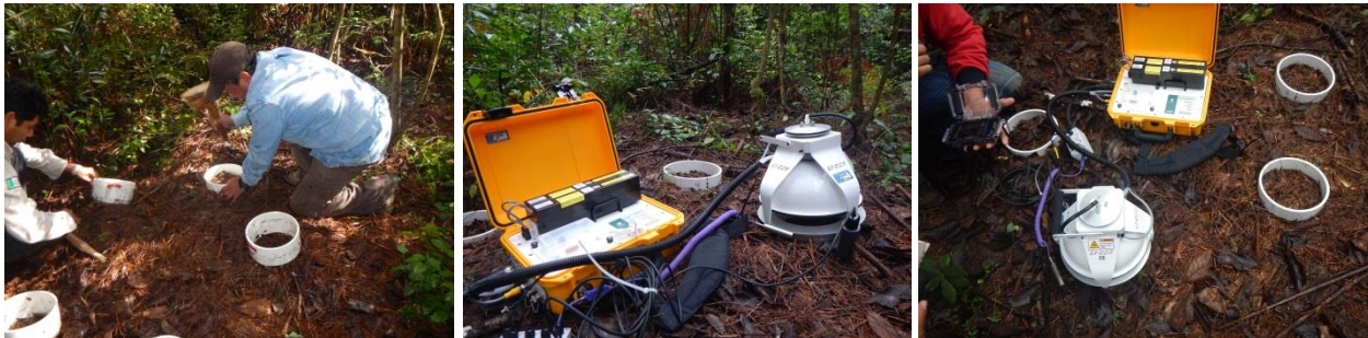
Figura 34. Instalación de anillos y medición del flujo de CO 2 del suelo con el equipo LI-8100A Automated Soil Gas Flux System en el SMIC-Hidalgo.
