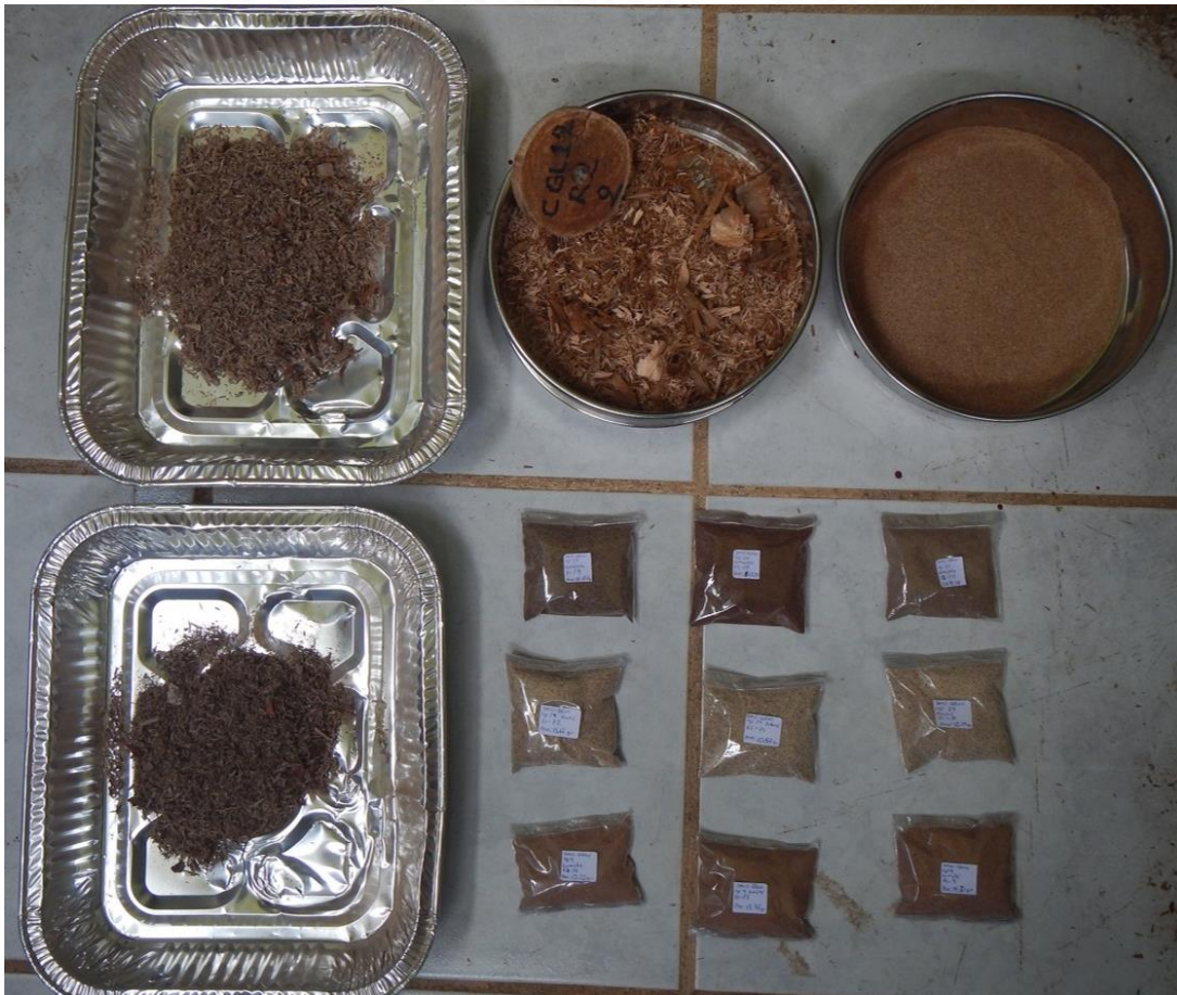
Figura 42. Proceso de trituración, molienda y de ramas derivadas de los ensayos de descomposición
