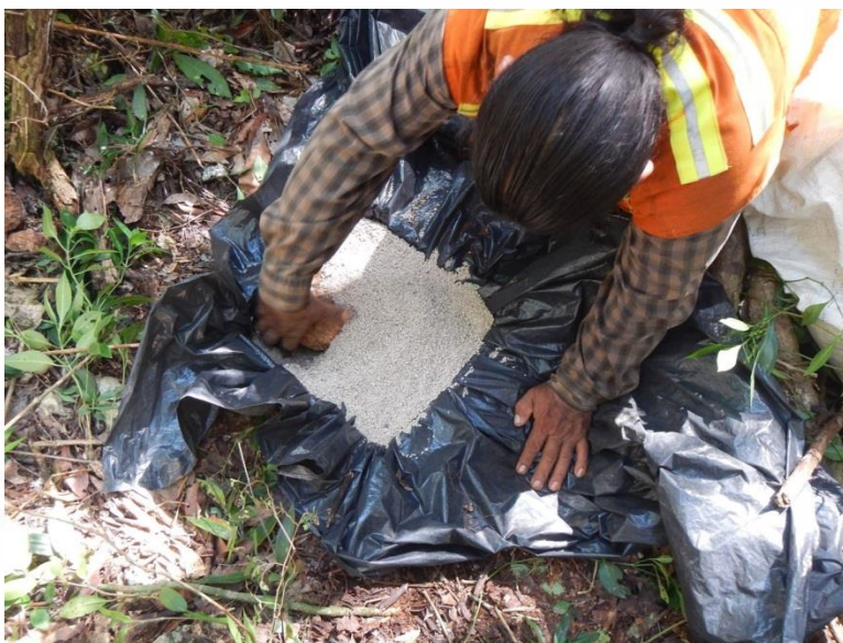
Figura 26. Determinación del volumen del hueco con perlita
