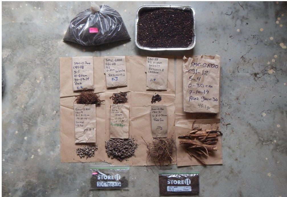
Figura 29. Separación de la submuestra de suelo en componentes, suelo mineral, raíces gruesas y finas
