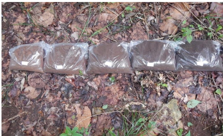
Figura 27. Muestras de suelo tomadas a diferente profundidad, en un punto de muestreo Posterior a la extracción del suelo, en cada profundidad (0-10, 10-20, 20-30, 30 a 50 y de 0-30) se tomó la profundidad real (Figura 28) a la cual se cavó, esto para representar con mayor precisión la profundidad real del muestreo, ya que en muchos casos no se alcanzó la profundidad establecida, debido a los afloramientos de rocas que caracterizan el suelo de la Península de Yucatán.
