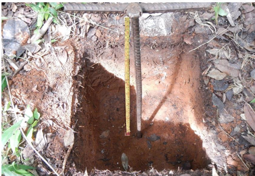
Figura 28. Registro de la profundidad máxima en cada punto de muestreo
