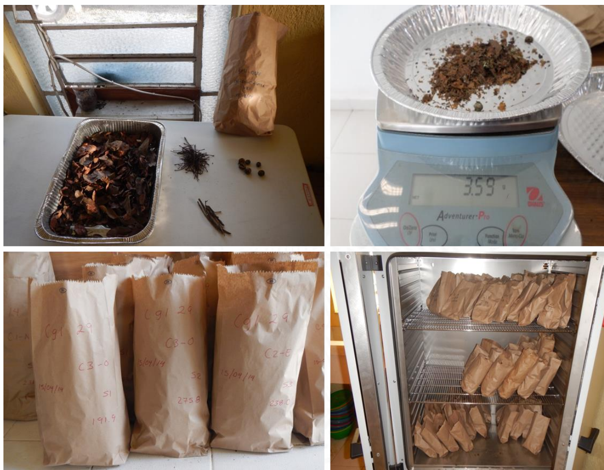
Figura 34. Representación de los distintos pasos del procesamiento de la hojarasca en laboratorio. Cada componente se depositó en bolsas de papel y se puso a secar en la estufa de circulación forzada a 70 °C de temperatura, por 24 horas. Finalmente, se registró el peso seco de cada componente y se capturó en los formatos de laboratorio previamente elaborados.
