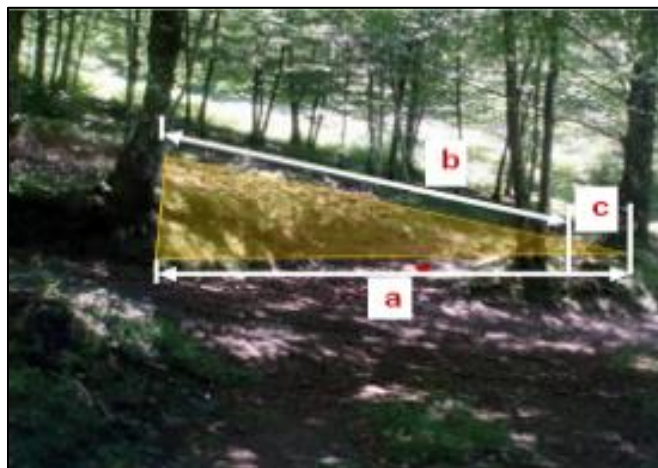
Figura 8. Efecto de la pendiente en la distancia horizontal. Distancia horizontal (a); distancia medida sobre un terreno con pendiente (b); diferencia entre la distancia horizontal y la distancia medida sobre el terreno (c).
