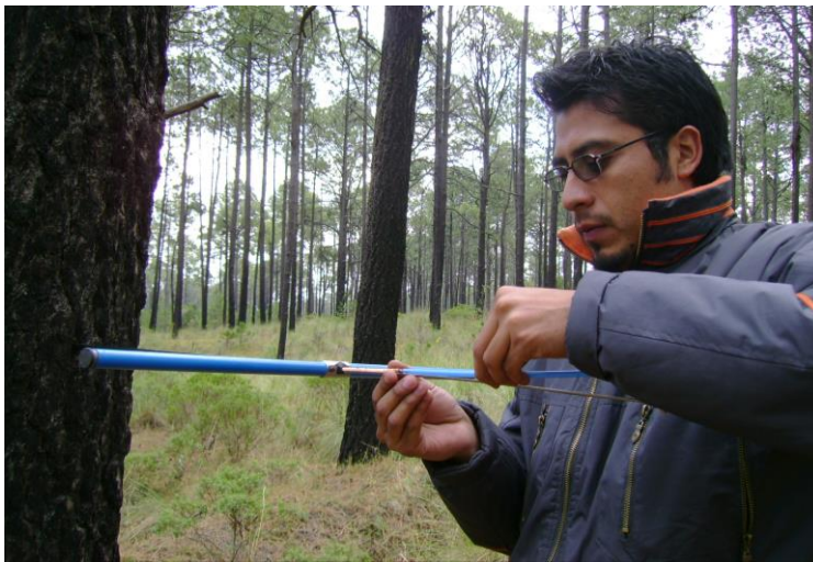
Figura 20. Toma de muestra de madera para conteo de anillos de crecimiento
