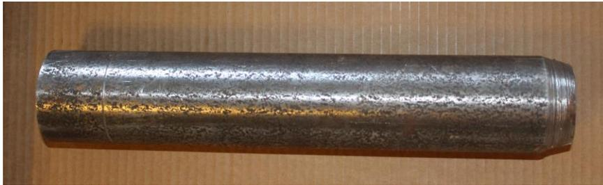
**Figura 18. Cilindro de metal para la toma de muestra de suelo del punto DAP**
