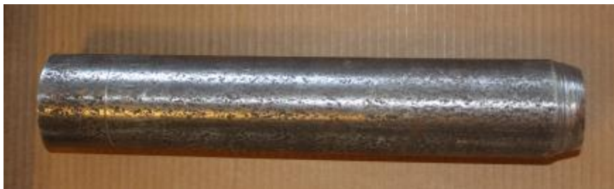
Figura 13. Cilindro de metal para la toma de muestra de suelo del punto DAP
