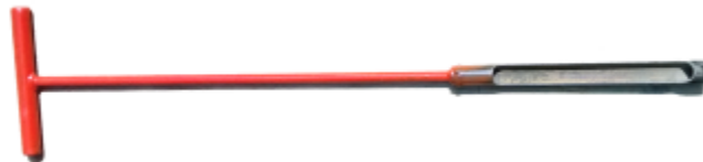
Figura 15. Barreno de tubo para la extracción de suelo
