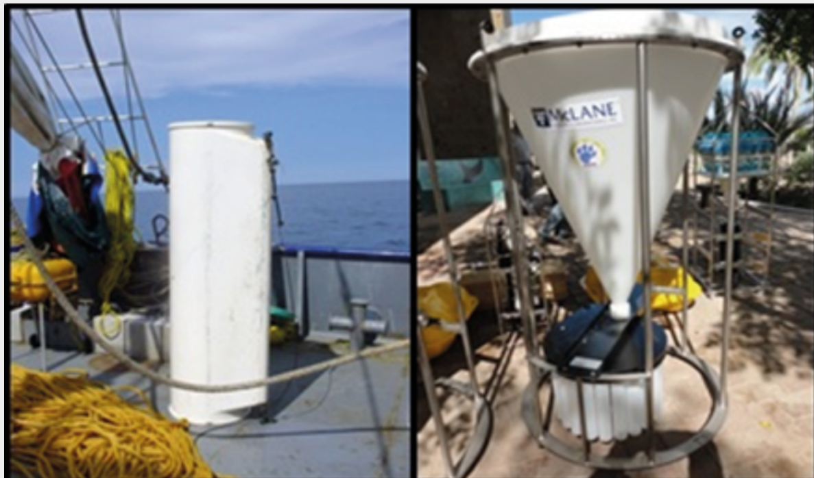
Figura C1.1. A la izquierda, TS cilindro-cónica de Technicap modelo PPS 3/3 de 0.125 m 2 de área y 12 botellas colectoras de 250 mL de capacidad. Intervalo de muestreo de 1 h hasta 60 días. Instalación continua máxima hasta por 18 meses y a una profundidad de hasta 6000 m. A la derecha, TS cónica de la compañía McLane Research Labs Inc. (MRL) modelo Parflux Mark 78H-21 de 0.5 m 2 de abertura de colecta con 21 botellas colectoras de 500 mL de capacidad. Intervalo de muestreo de 1 minuto en adelante. Instalación continua máxima hasta por 18 meses y a una profundidad de hasta 7000 m.
