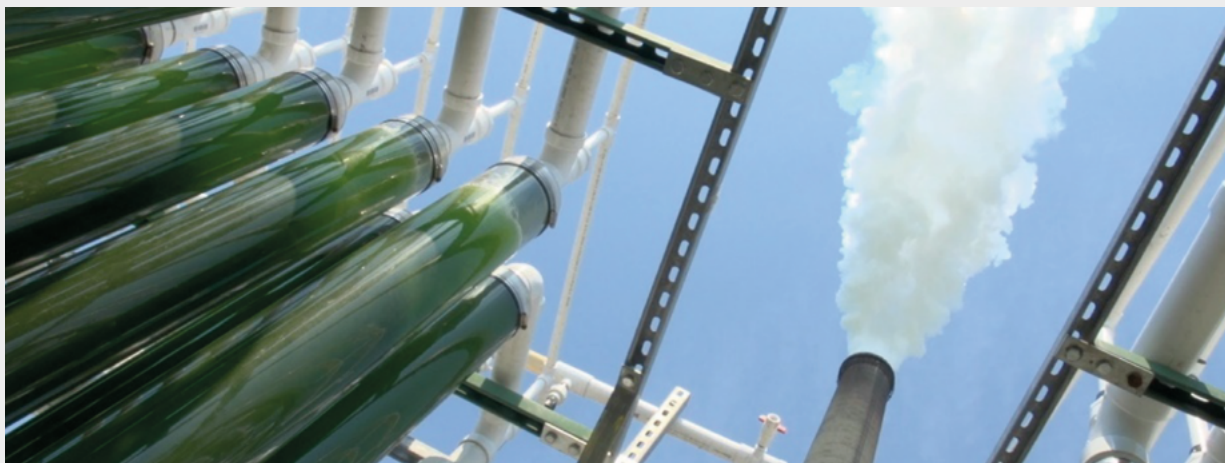
Figura C7.1. Sistema de microalgas para la captura de emisiones de CO 2 provenientes de una planta carboeléctrica. Fuente: Hautala (2013).
