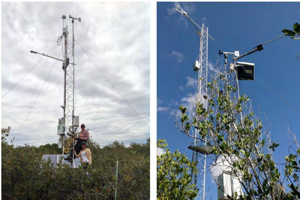
**Figura 1.** Instrumentación para el monitoreo de flujos de CO<sub>2</sub>. Sistema de Covarianza de Vórtices en: a) Sitio perturbado y b) Sitio conservado.
