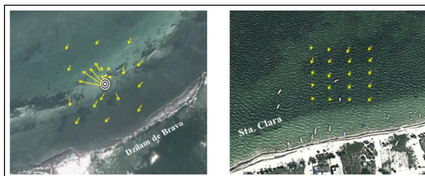
**Figura 5.** Distribución de las corrientes superficiales y velocidades de flujo del manantial.
