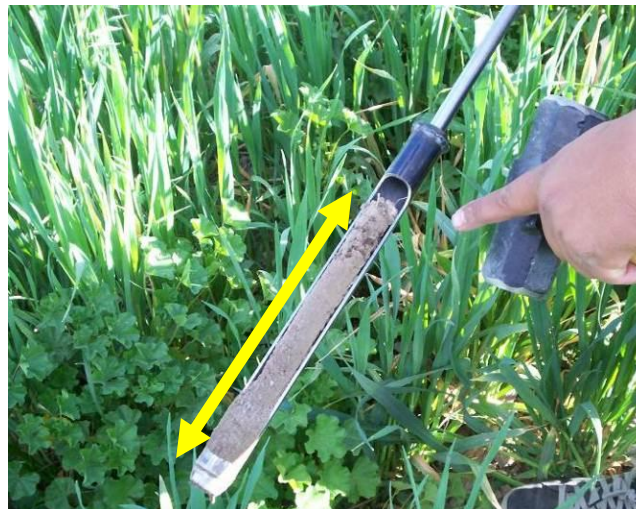
Figura 4.4.10.8.4 Profundidad efectiva de la muestra recolectada.
