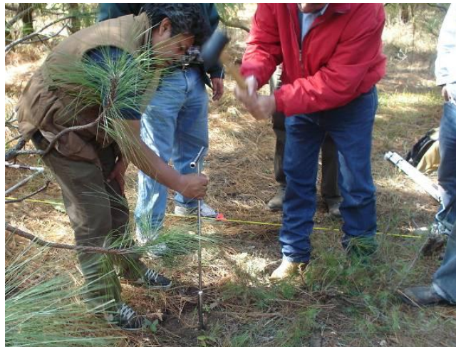
Figura 4.4.10.8.2 Introducción de la barrena de tubo para el muestreo de suelo.
