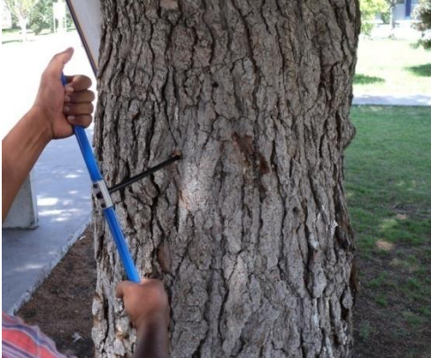
Figura A.3.2. Taladro de Pressler en movimiento en el interior de un fuste de pino.
