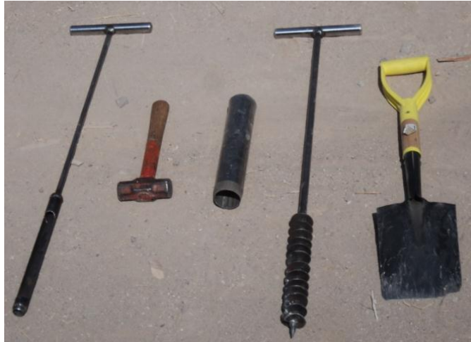
Figura 4.4.10.8.1 Materiales empleados para la extracción de muestra de suelos.
