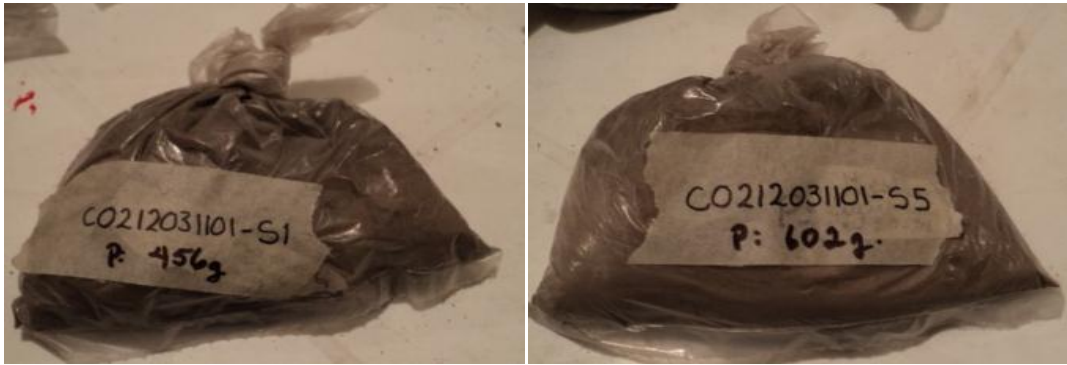
Figura 4.4.10.9.1 Ejemplo de etiquetado de muestras de suelo.
