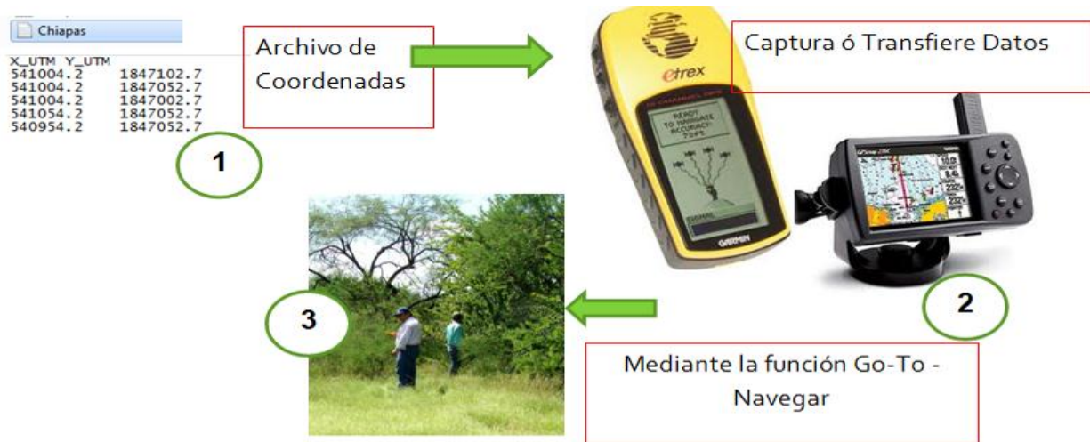
Figura 4.4.4.3 Opción 2. Esquema de incorporación de datos al GPS cuando no soporten el formato shape.
