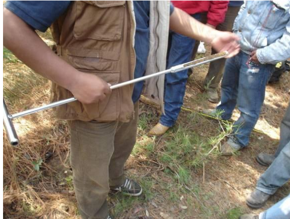
Figura 4.4.10.8.3 Vista lateral de la barrena de tubo de muestreo.
