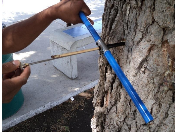
Figura 4.4.11.2.5 Taladro en el interior de la corteza de un Pinus alepensis . Note la varilla con la cual se obtiene la viruta uniforme de 0.5 cm de diámetro.
