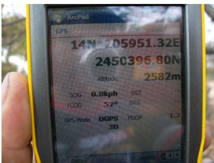
Figura 3.1. Fotografía de la pantalla del GPS, tomada en el centro de la parcela con datos nítidos de coordenadas UTM y PDOP.
