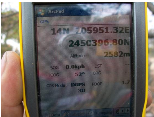
Figura 3.1. Fotografía de la pantalla del GPS, tomada en el centro de la parcela con datos nítidos de coordenadas y PDOP.
