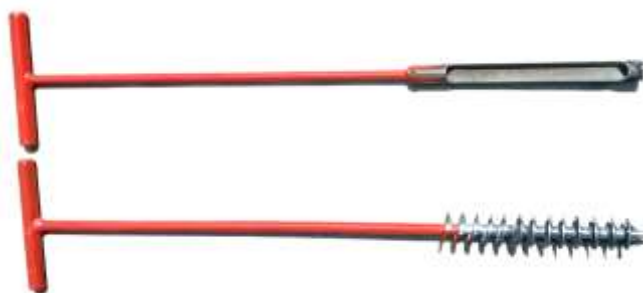
Figura 22. Barrenos para la extracción de suelo en las unidades de muestreo 1 a 8.
