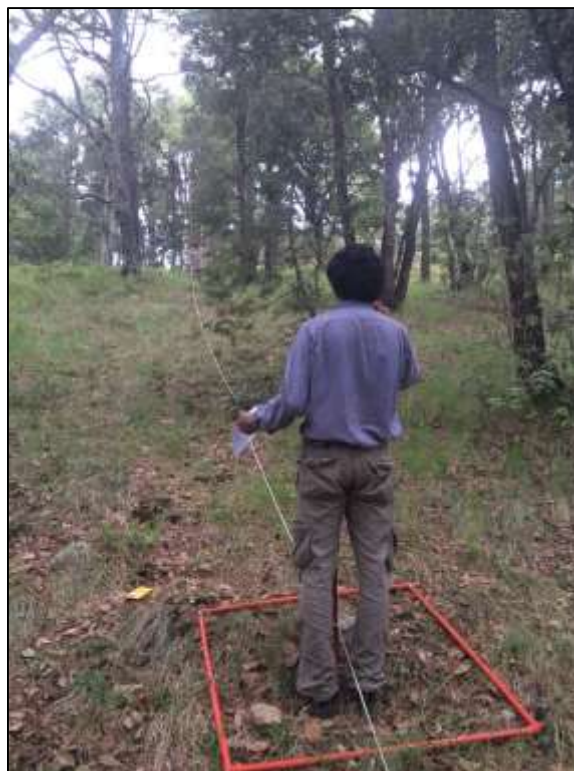
Figura 7. Direccionamiento de las cuerdas que delimitan la parcela desde el punto central
