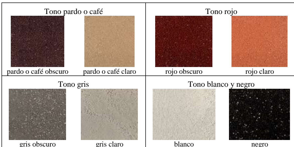
Figura 30. Tonos e intensidades de color del suelo (pardo o café, rojo, gris, blanco y negro), de acuerdo al sistema de color Munsell.
