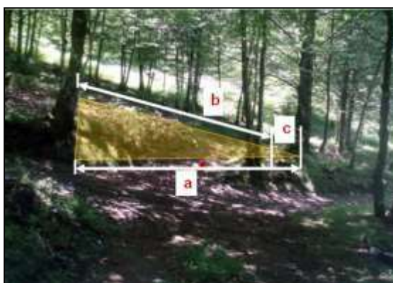
Figura 11. Efecto de la pendiente en la distancia horizontal. Distancia horizontal (a); distancia medida sobre un terreno con pendiente (b); diferencia entre la distancia horizontal y la distancia medida sobre el terreno (c).
