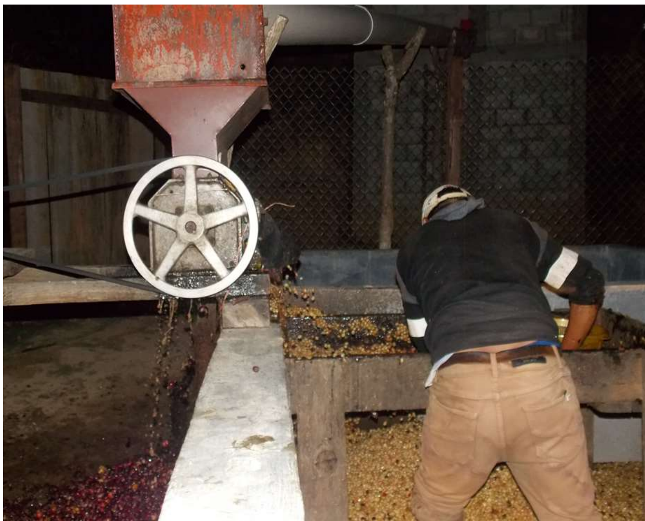
Figura 7. Proceso de despulpado mecánico de café, en el que separa el grano de la pulpa y cascarilla.
