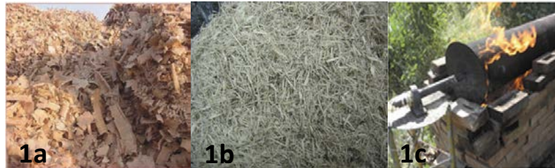
Figura 1. Vista de los residuos de aserrín (1a) y de caña de azúcar (1b) usados para obtener los biocarbones (biochar) y del tubo metálico (1c) usado para su elaboración.
