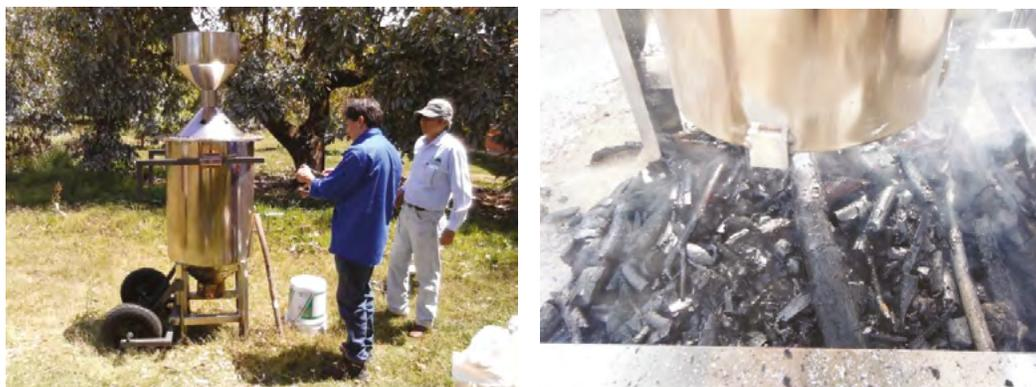
**Figura 2.** Reactor de pirólisis autotérmico de acero inoxidable para fabricar biocarbón a partir biomasa vegetal.
