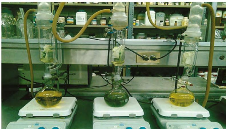
**Figura 2.** Extracción lipídica en Soxhlet.
