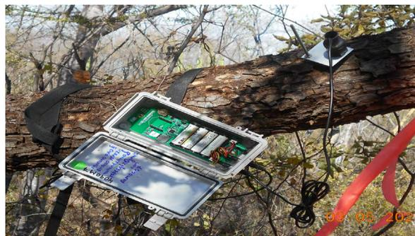
Figura 3. Dendrómetro instalado en un individuo de *L. watsonii* en el bosque tropical seco.
