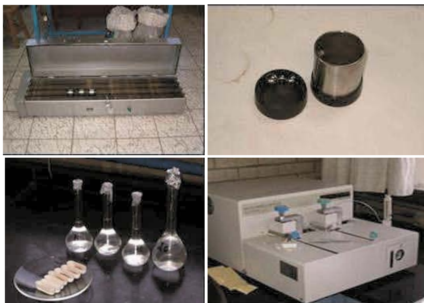
Figura 5. Fotos de arriba: molino de balines para pulverizado de muestras vegetales y de suelo. Fotos de abajo: análisis de muestras sólidas para la determinación del contenido de carbono.
