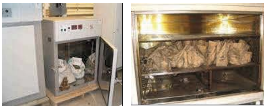
Figura 4. Secado de muestras para obtener peso constante.
