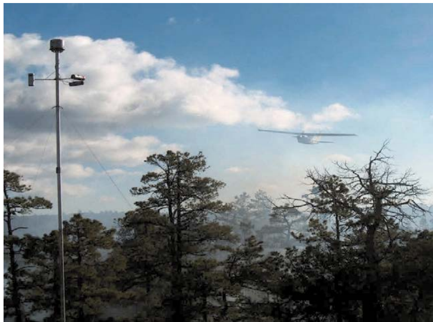
Figura 1. Torre donde se ubicaron los sensores láser en la evaluación de la calidad de humo, y vuelo del avión Cessna que se usó para capturar muestras de humo a diferentes alturas.
