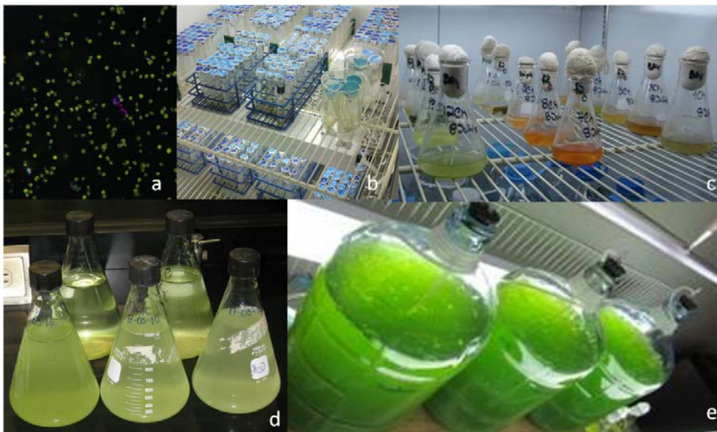
Figura 1. Proceso de escalamiento (a) microfotografía de un cultivo en fase de crecimiento exponencial, (b) tubos con 10 ml de cultivo, (c) matraces con 100 ml de cultivo, (d) matraces con 1 L de cultivo que se utilizaron para inocular a los biorreactores de 16 L de cultivo (e).
