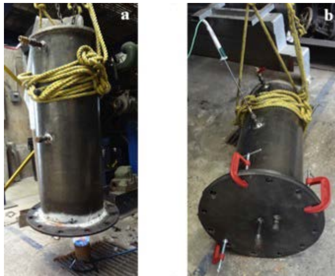
Figura 1. Reactor utilizado para la producción de biocarbón: (a) precalentamiento de la cámara interior del reactor, (b) reactor cerrado con la biomasa en el interior.
