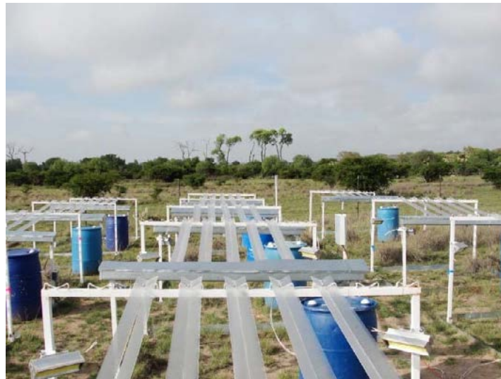
Figura 1. Canaletas construidas para la manipulación de la precipitación.
